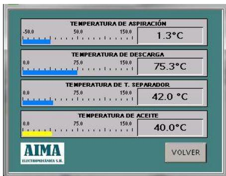
En esta página pueden verse las mediciones de temperatura en la línea de aspiración, en la línea de descarga, así como las temperaturas en el tanque separador y de aceite.
