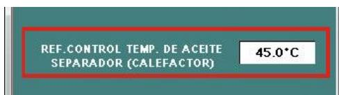
Este control actúa cuando la máquina se encuentra detenida y su finalidad es mantener el aceite precalentado al momento del arranque. El control de la temperatura se realiza con una resistencia calefactora ubicada en el fondo del tanque separador y el método de control es del tipo ON-OFF con histéresis.
