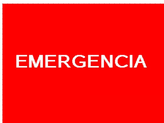
*En el caso de presionarse el botón de emergencia del equipo el mismo se deshabilita para el funcionamiento (en caso de que estuviese detenido) o se detiene (si estaba en marcha) y en la pantalla aparece el mensaje que muestra la figura.*
