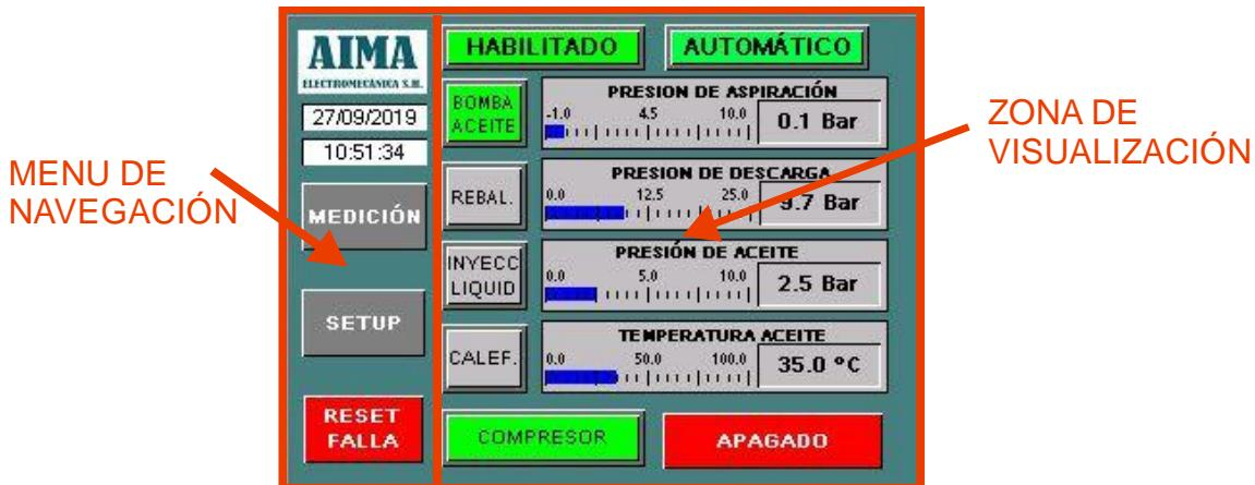
El menú de navegación muestra, en la parte superior, la fecha y la hora, y siguiendo hacia abajo los botones que permiten acceder a las distintas secciones de operación, medición y configuración.
