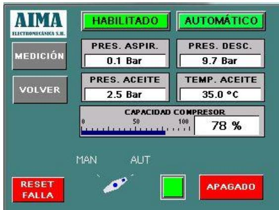
En esta página se configura el modo de funcionamiento del compresor: MANUAL, AUTOMÁTICO o REMOTO.
