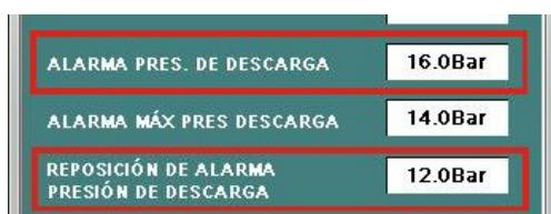
Esta alarma se activa cuando el compresor se encuentra en funcionamiento. Se mide la presión de descarga y se compara con el valor programado, y en el caso de superarse esta temperatura se activa la alarma. A partir de la aparición de esta alarma se inicia un procedimiento de seguridad que comienza inhibiendo la posibilidad de aumento de la capacidad del compresor. Si la presión continúa aumentando y supera al valor programado en mas de 1 Bar. se procede a reducir la capacidad del equipo.
