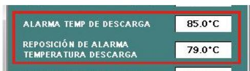
Esta alarma se activa cuando el compresor se encuentra en marcha. Se mide la temperatura de descarga y se compara con el valor programado y, en el caso de superarse esta temperatura, se activa la alarma. A partir de la aparición de esta alarma se inicia un procedimiento de seguridad que comienza inhibiendo la posibilidad de aumentar la capacidad del compresor, si la temperatura continúa aumentando y supera al valor programado en 1 °C se procede a reducir la capacidad del equipo.
