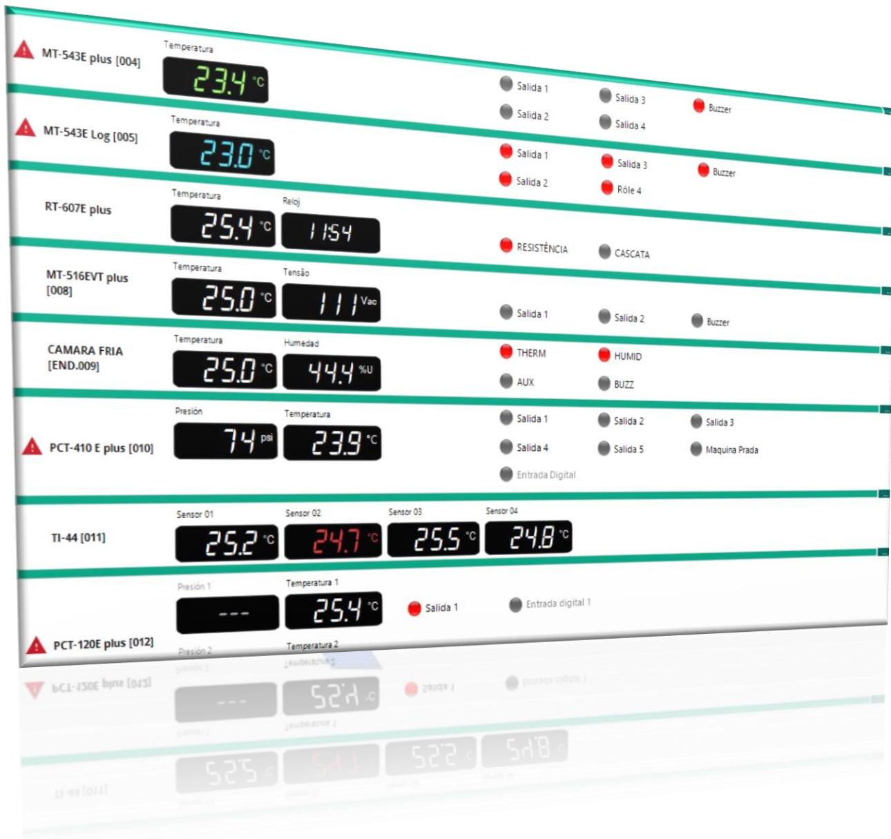
La facilidad de visualización de las temperaturas y/o humedad de manera unificada en una pantalla, permite a los operarios identificar de manera más rápida los problemas en las instalaciones.
